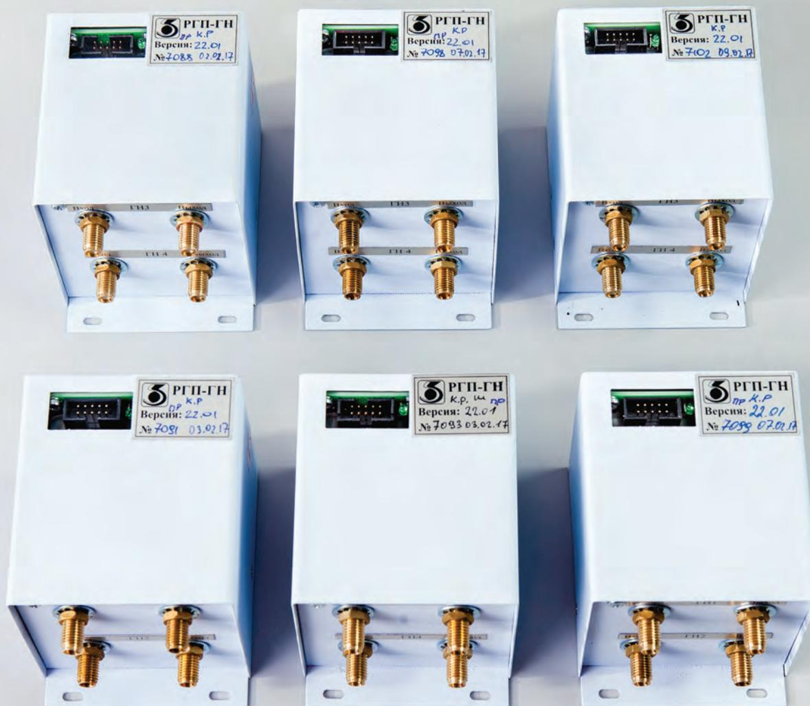
Рис. 5. Универсальные регуляторы газовых потоков (РГП)
