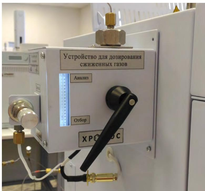
Устройство для дозирования сжиженных газов с краном Valco
