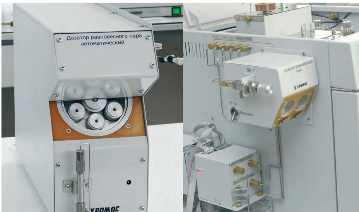
Дозатор равновесного пара автоматический
