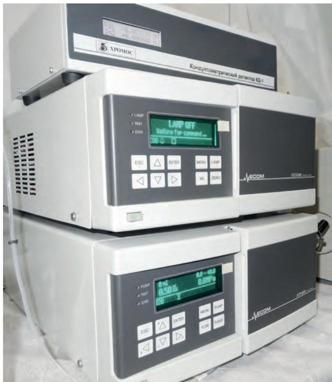
Жидкостный хроматограф с кондуктометрическим детектором
